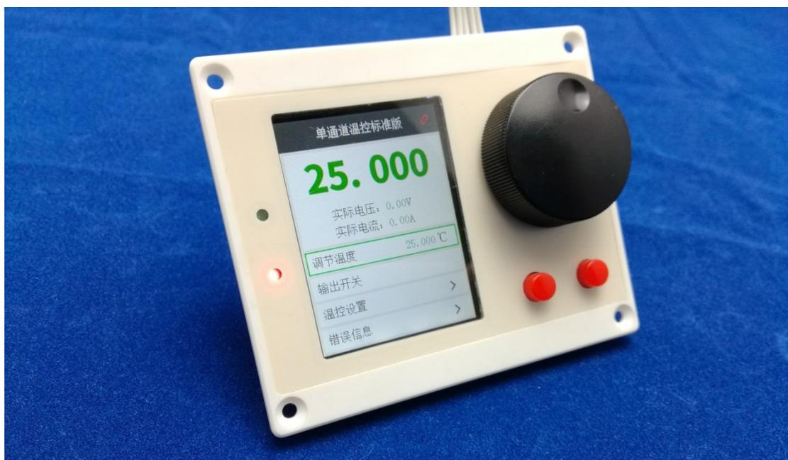
我司的产品的一个最主要的特点就是产品的参数可以设置。大多数情况下，可以通过电脑连接产品的串口，用上位机软件进行设置。
